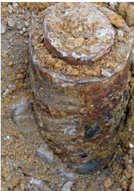
Freigelegtes Eisenrohr einer Altbohrung (Bild 6.1-8)
