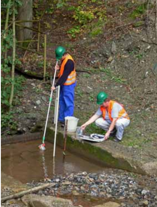
Probenahme des Sickerwassers am Kleinstabecken am Fuß Halde 371/II, September 2008 (Bild 2.2-1)
