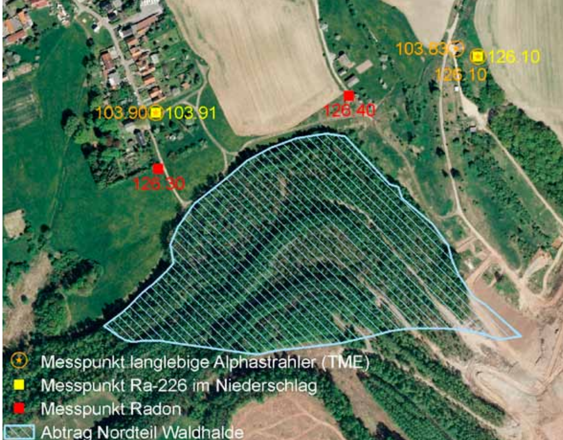
Messpunkte der Radonkonzentration, von Ra-226 im Staubniederschlag und der Konzentration langlebiger Alphastrahler im Schwebstaub in der angrenzenden Ortschaft Wolfersdorf (Bild 8.2-4)
