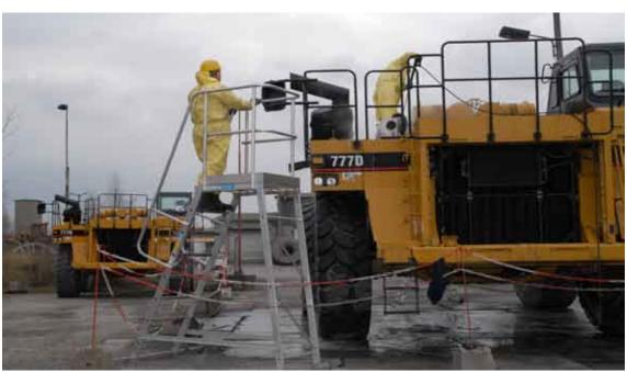
Bild 9.5-1 Großgerätetechnik wird dekontaminiert
