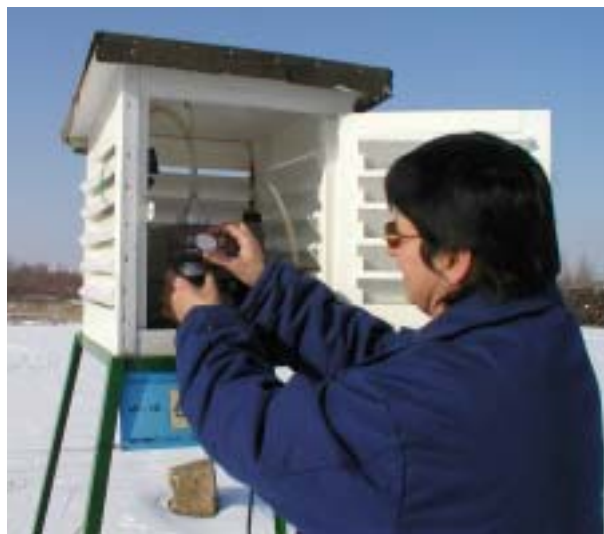
Bild 4.2.2-6 Filterwechsel bei Schwebstaubmessung und Bestimmung langlebiger Alphastrahler
