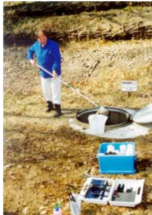
Bild 4.2.1-2 Beprobung gefaßter Sickerwässer des unteren Borbachtals am Fuß der Halde Borbachdamm der NL Aue; Meßstelle m-108X; Probennehmer beim Herstellen einer qualifizierten Stichprobe
