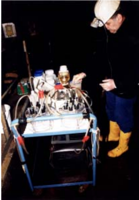
Bild 4.2.1-7 Grundwasserprobenahme Grube Königstein, Meßpunkt k-7080
