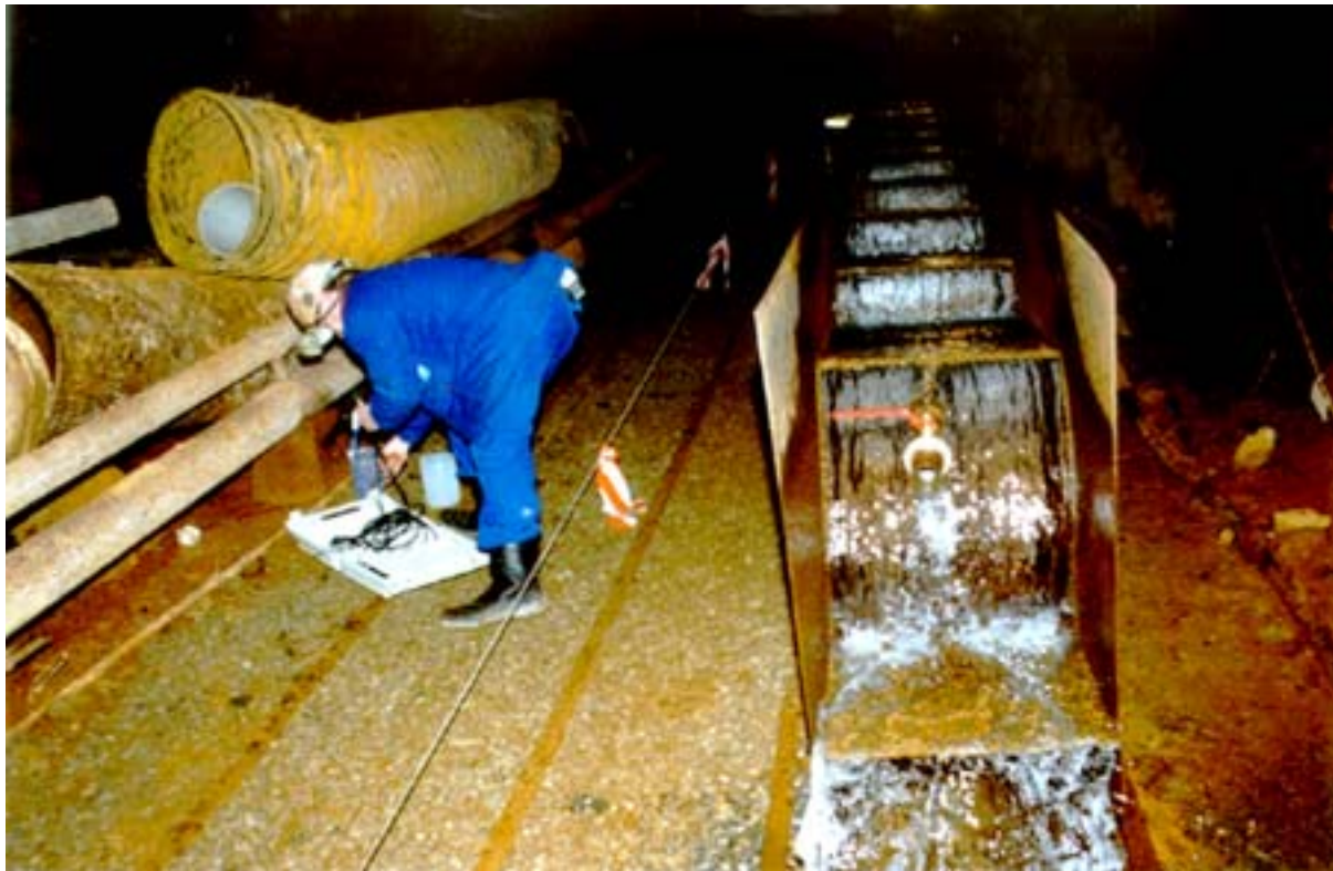
Bild 4.2.1-5 Pilotanlage zur In-situ-Flutungswasserbeeinflussung in der Grube Pöhla; Probenehmer des SC Umweltmessungen Aue bei der In-situ-Parameterbestimmung im Rahmen der Wasserprobenahme am Ablauf der Belüftungskaskade
