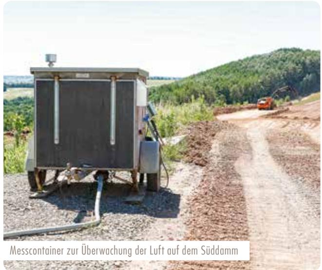
Messcontainer zur Überwachung der Luft auf dem Südamm
