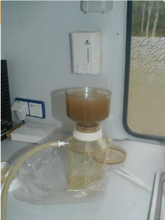
Bild 6.2-6 Wasserprobe wird vor Ort membranfiltriert
