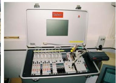
Bild 2.2-8 Seismische Überwachungsanlage SÜA 3 – Teilanlage Oberschlema
