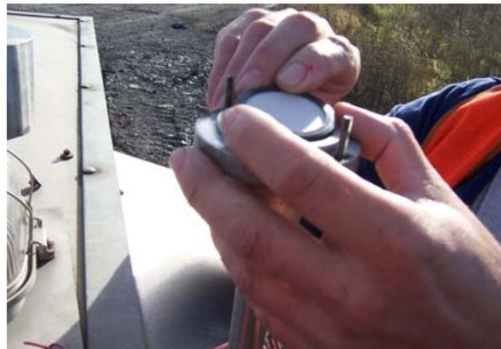
Bild 6.2-8 Filterwechsel an einem Staubprobensammler zur Messung langlebiger Alphastrahler im Schwebstaub
