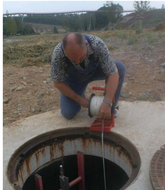
Bild 6.2-4 Mitarbeiter beim Messen des Wasserstandes, im Hintergrund Brücke „Drachenschwanz“
