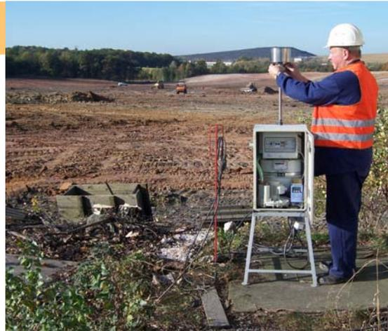
Bild 6.2-7 Sanierungsbegleitende Messungen von langlebigen Alphastrahlern beim Abtrag Halde Paitzdorf, Oktober 2006
