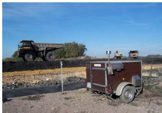
Bild 6.2-9 Transportable Messstation zur Überwachung des Haldenabtrages Paitzdorf zum Tagebau Lichtenberg, Oktober 2006
