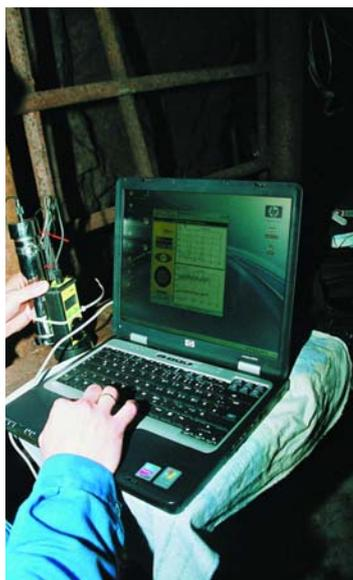
Bild 4.1.2-3 Messgerät DOSEMAN zur kontinuierlichen Bestimmung der Radonkonzentration unter Tage
