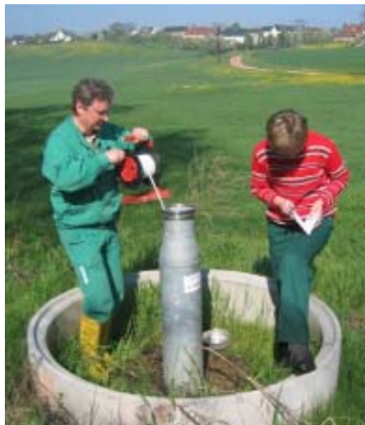
Bild 4.2.1-13 Wasserstandsmessung an einer Grundwassermeßstelle (e-1363) des Austrittsmonitorings in der Nähe des Lammsbaches, im Hintergrund Naulitz, April 2004
