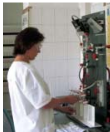
Bild 4.2.1-8 Evakuieren der Emanieröhrchen am Emanierstand im Labor am Standort Königstein, August 2004
