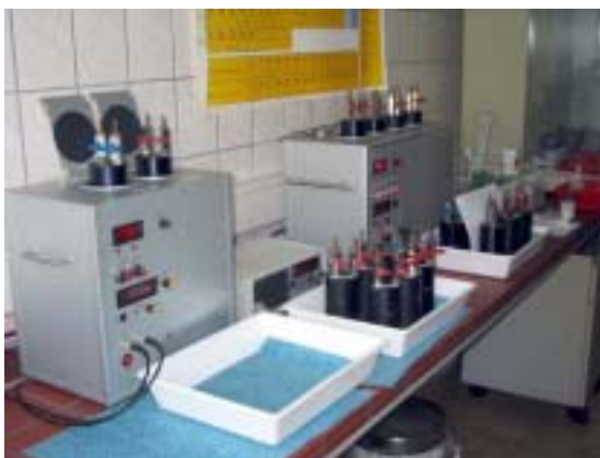
Bild 4.2.1-7 Emanometriemeßplatz für die Bestimmung von Ra-226 im Labor Königstein, August 2004
