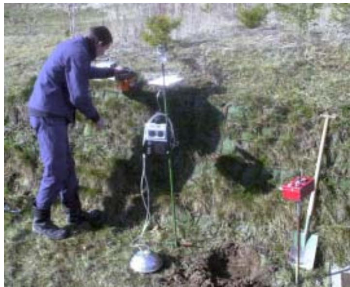
Bild 4.2.2-2 Mitarbeiter der Abteilung Umweltüberwachung/ Strahlenschutz bei Exhalationsmessungen auf der Hammerberghalde zur Kontrolle des Sanierungserfolges
