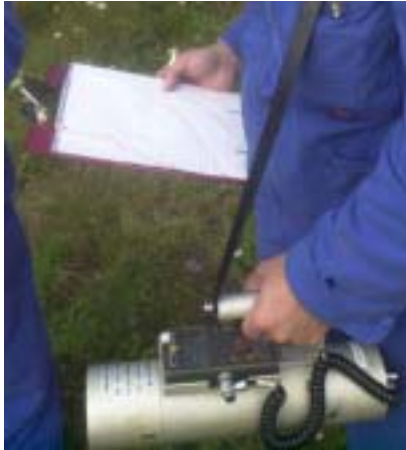
Bild 4.2.2-3 ODL-Messung auf abgedeckten Halden, Meßwertermittlung mit dem ODL-Gerät: Szintomat 6150 AD 6 / Szintilatorsonde
