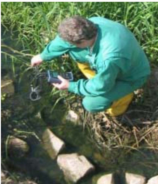
Bild 4.2.1-12 Messung der Leitfähigkeit in der Großensteiner Sprotte im Rahmen der quartalsweisen Begehung zur Flutungsüberwachung am Standort Ronneburg, April 2004
