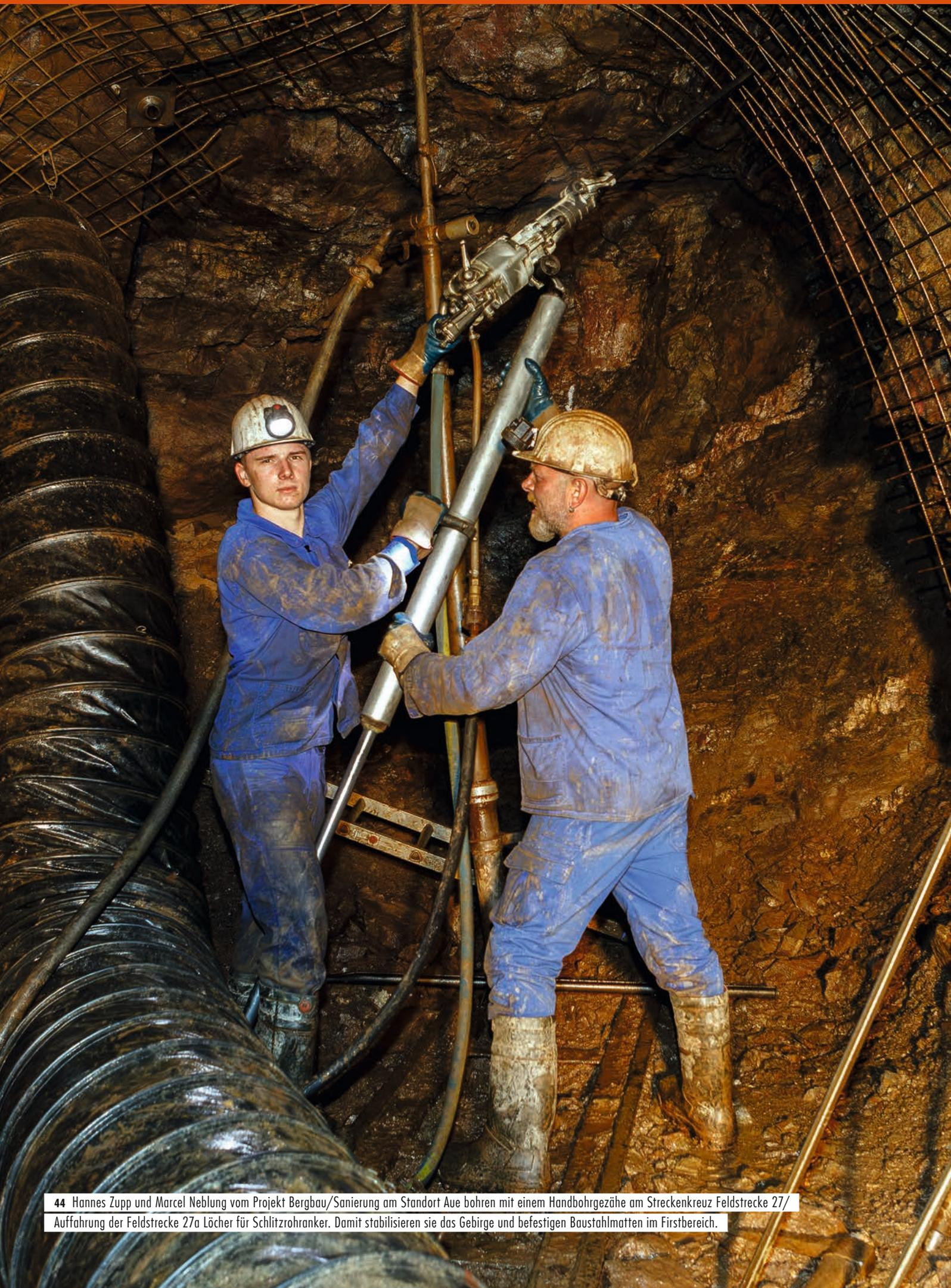
44 Hannes Zupp und Marcel Neblung vom Projekt Bergbau/Sanierung am Standort Aue bohren mit einem Handbohrgezáhe am Streckenkreuz Feldstrecke 27/
