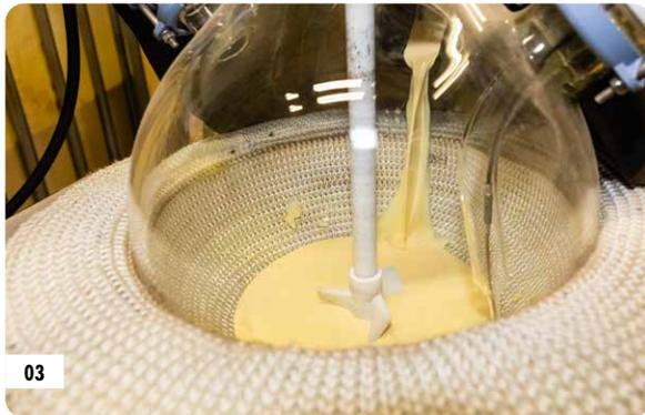
eine Flasche direkt ab. Diese begleitete später den Transport. Mit einer weiteren Menge befüllten die Kollegen schließlich einen Glaskolben ausgestattet mit Rührwerk und Heizelement.
